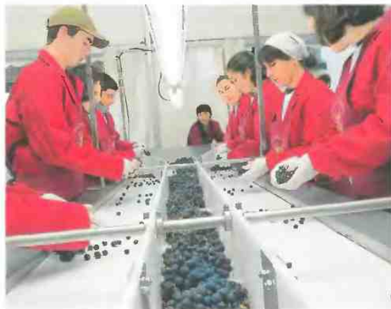
В хороших винодельческих хозяйствах практикуют выбраковку всех недозрелых и гнилых ягод. На фото: сортировка винограда и ручное гребнеотделение в Шато Пап-Клеман
