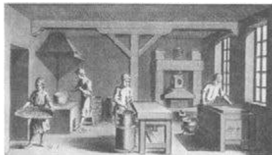
Fabrication du chocolat d'après l'Encyclopédie. De gauche à droite : ouvrier qui vanne des amandes de cacao; ouvrier qui torréfie du cacao; ouvrier qui pile des amandes; ouvrier qui broie du chocolat.
