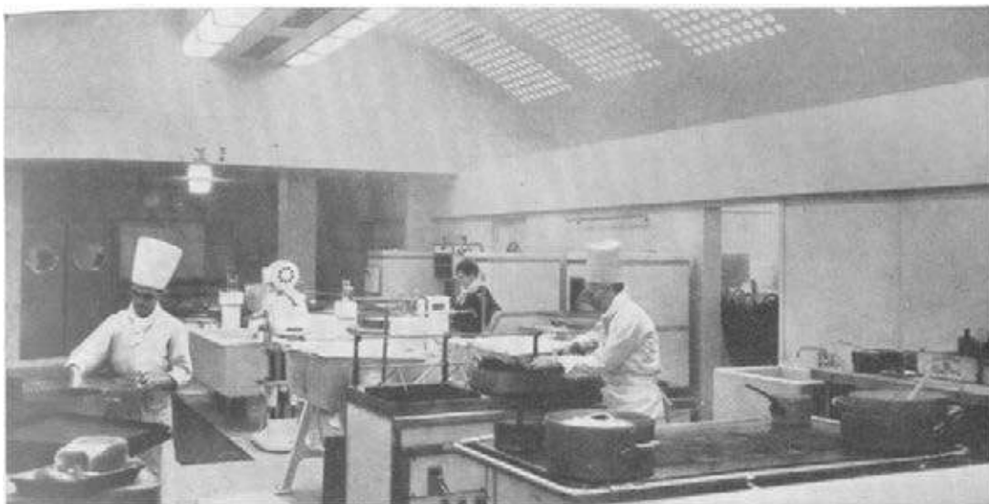
Cuisine du réfectoire du personnel de la Compagnie Parisienne de Distribution d'Electricité. Tous les appareils fonctionnent à l'électricité : on voit le fourneau, les frittiers, les bacs mélangeurs, les fours, une salamandre. (Phot. C.P.D.E.)
