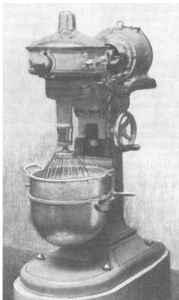
Machine électrique de grand restaurant pour monter les sauces mayonnaises et autres. (Système Navarre. Phot. J. Bayer.)
